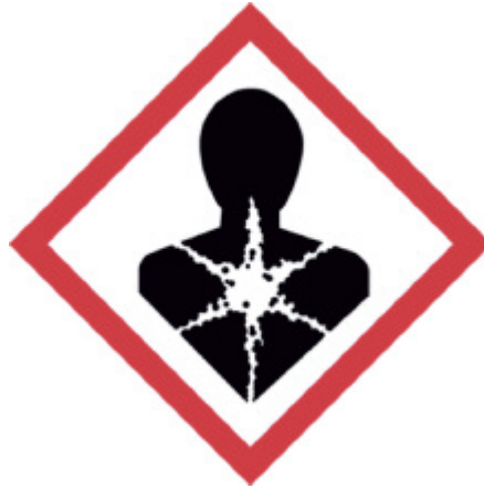
Fig. 1. Le symbole du torse GHS08 indique notamment des substances cancérogènes, mutagènes et reprotoxiques, qui sont particulièrement problématiques pour les femmes enceintes et les jeunes travailleurs. Il est donc important de vérifier quels sont les dangers de tels produits et comment ils peuvent être utilisés avec sûreté.
