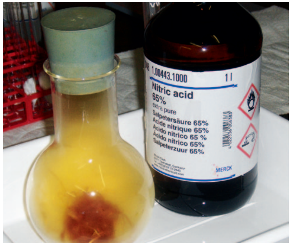
Reaktion eines Gefahrstoffs: Salpetersäure (Lagerklasse 8) bildet mit dem Verpackungsmaterial aus Holzwolle (Nichtgefahrstoff) stark toxisches Nitrosegas.
