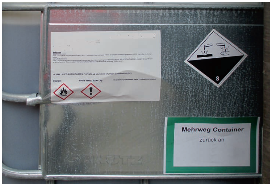
Abb. 2: falsch gekennzeichnete IBC-Container.
