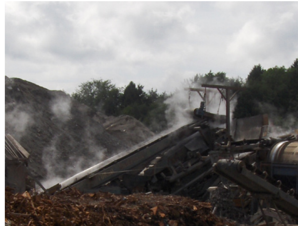
Bei der offenen Verarbeitung von KVA-Schlacken, z.B. zur Metall-Rückgewinnung, können Nanopartikel als diffuse Emission in die Umwelt austreten.
